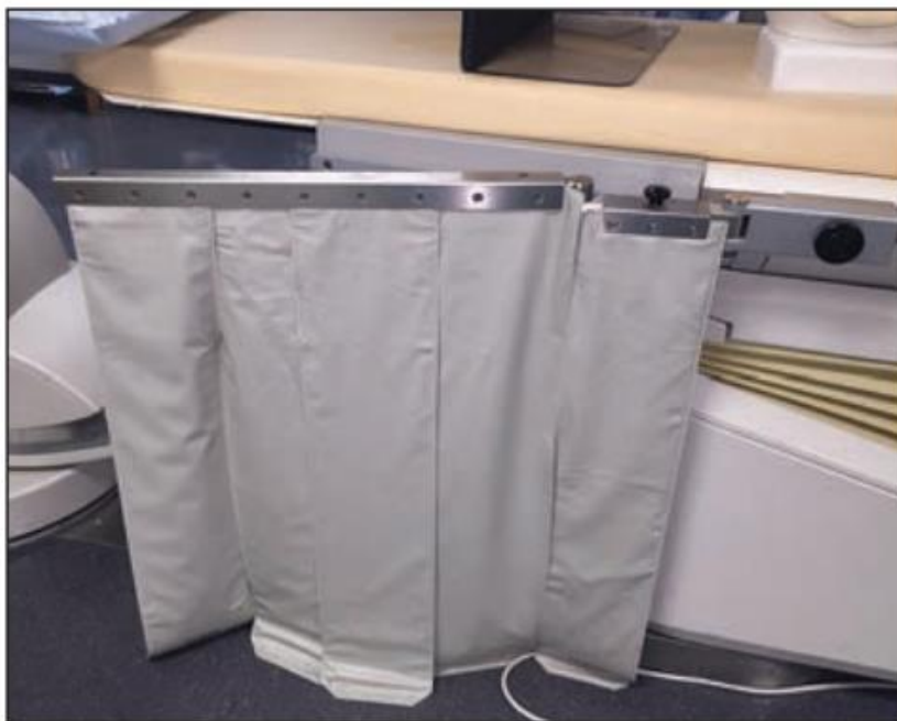
Figura 7: Cortina plumbífera alocada na lateral da mesa do paciente. Imagem retirada de [Meisinger et al. , 2016]
