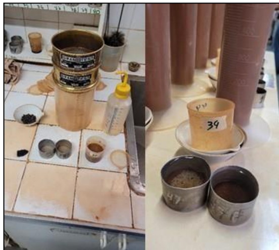
Figura 7: Conjunto de peneira, béqueres, pisceta e material com frações de areia separadas.
