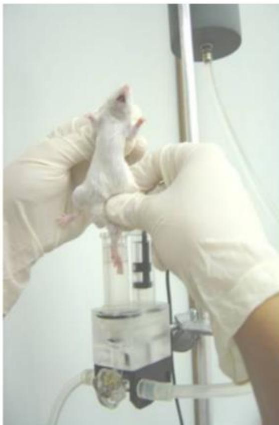
**Figura 5- Representação do equipamento de plethysmometro para avaliação do edema na pata.**
