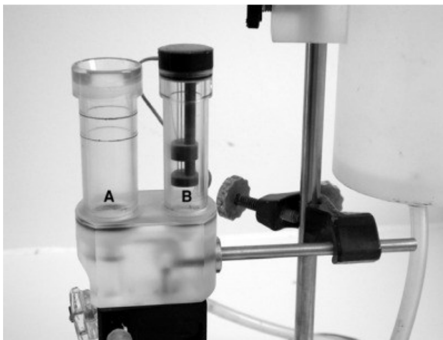
Figura 5: Pletismômetro. A compartimento tubular onde a pata do animal será imergida. B compartimento de igual volume de A contendo o transdutor de volume alterado em A. Imagens de autoria do autor
