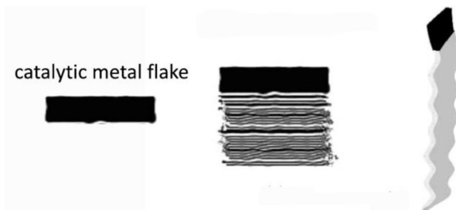
Figura 3. Ilustração esquemática do mecanismo típico de crescimento por deposição de vapor químico das nanofibras de carbono (NFCs) plaquetárias. Fonte: Zheng et al. (2006).
