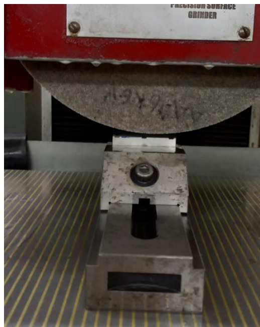
Figura 3.10 – Posicionamento da peça em uma morsa de precisão sobre a mesa magnética da máquina-ferramenta.
