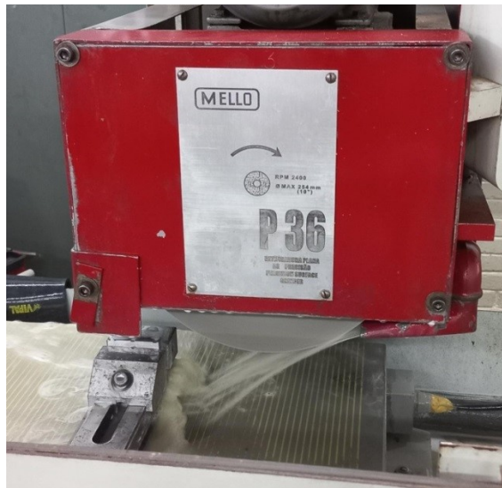
Figura 3.4 – Sistema Rebolo-Peça e fluido de corte.
