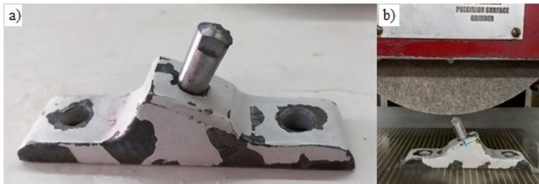
Figura 3.8 – Base com dressador utilizado nos ensaios a) sem posicionamento na máquina-ferramenta b) com posicionamento na máquina-ferramenta.
