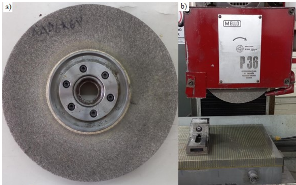
Figura 3.6 – Rebolo empregado nos ensaios, a) sem montagem na máquina-ferramenta e b) montado na máquina-ferramenta.
