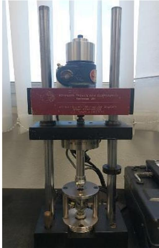
Figura 2.7 – Dispositivo de indentação *in situ* SSM-M1000™
