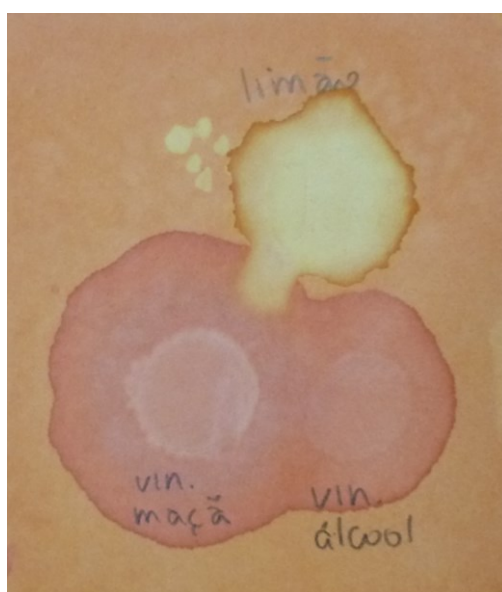
Figura 9. Teste de meios ácidos em papel emulsionado com Cosmos sulphureus (cosmos amarelo). Fonte: Arquivo pessoal.
