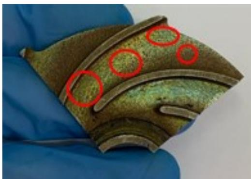
Figura 27 – Regiões escolhidas para análises micrográficas no componente Corte em Pizza da parte Interna do Impelidor 1.
