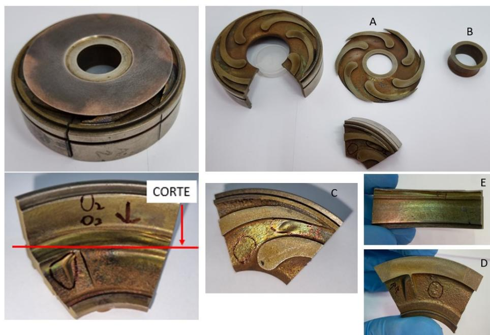
Figura 20 – Cortes realizados no Difusor 1: (A) Capa do Difusor 1; (B) Pad (C) Região Superior Interna do Difusor 1; (D) Região Inferior Interna do Difusor 1; (E) Região Interna da Lateral do Difusor 1.
