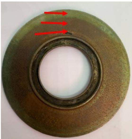
Figura 26 – Regiões escolhidas para análises micrográficas no componente Capa Externa do Impelidor 1.
