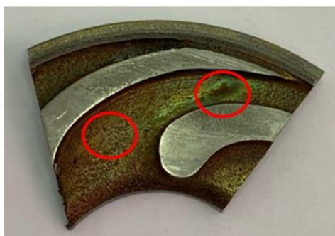
Figura 22 – Regiões escolhidas para análises micrográficas no componente Superior Interno do Difusor 1.
