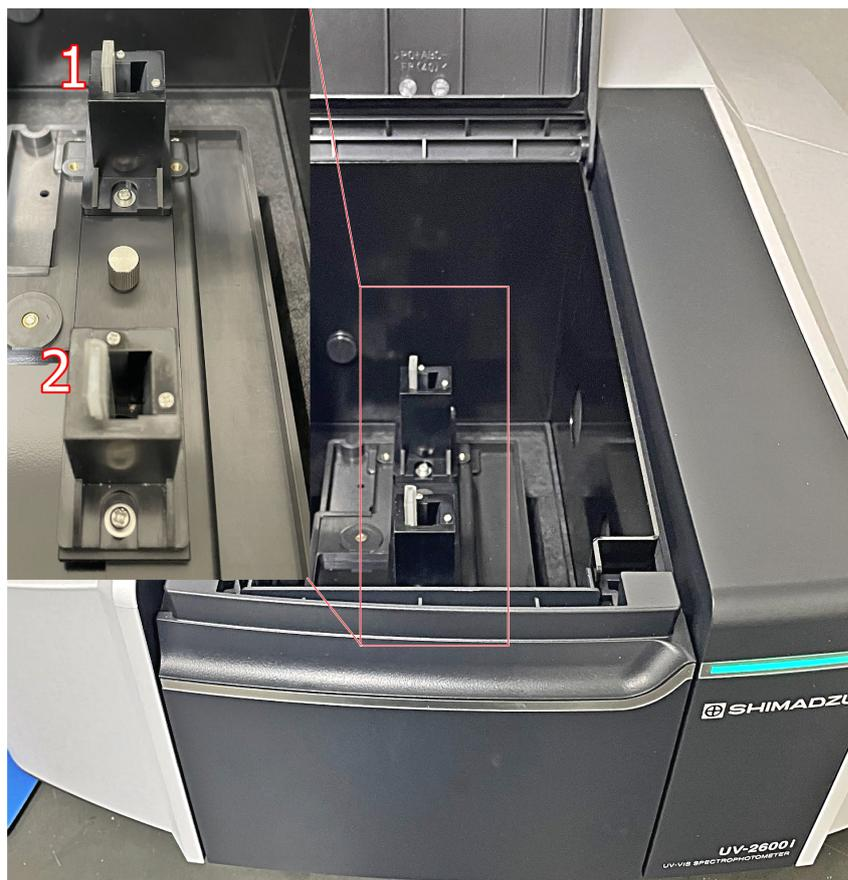
Figura 4 – Amostras no espectrofotômetro. Cubeta 1- Água milli-q para referência; Cubeta 2- Amostra a ser analisada.
