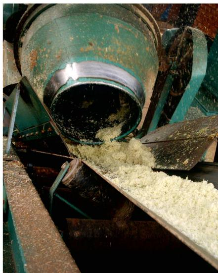
**Figura 7** – Moagem dos colmos para posterior análise da sacarose em laboratório.
