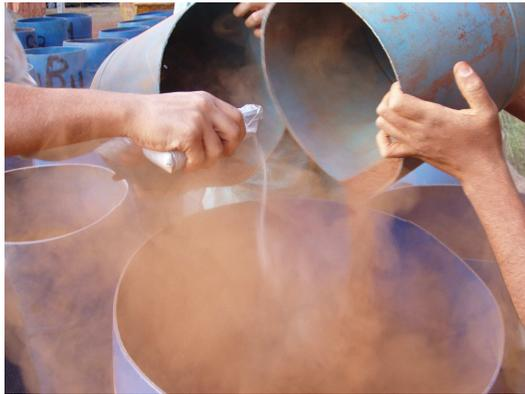
**Figura 2** – Adição de agregados siderúrgicos.
