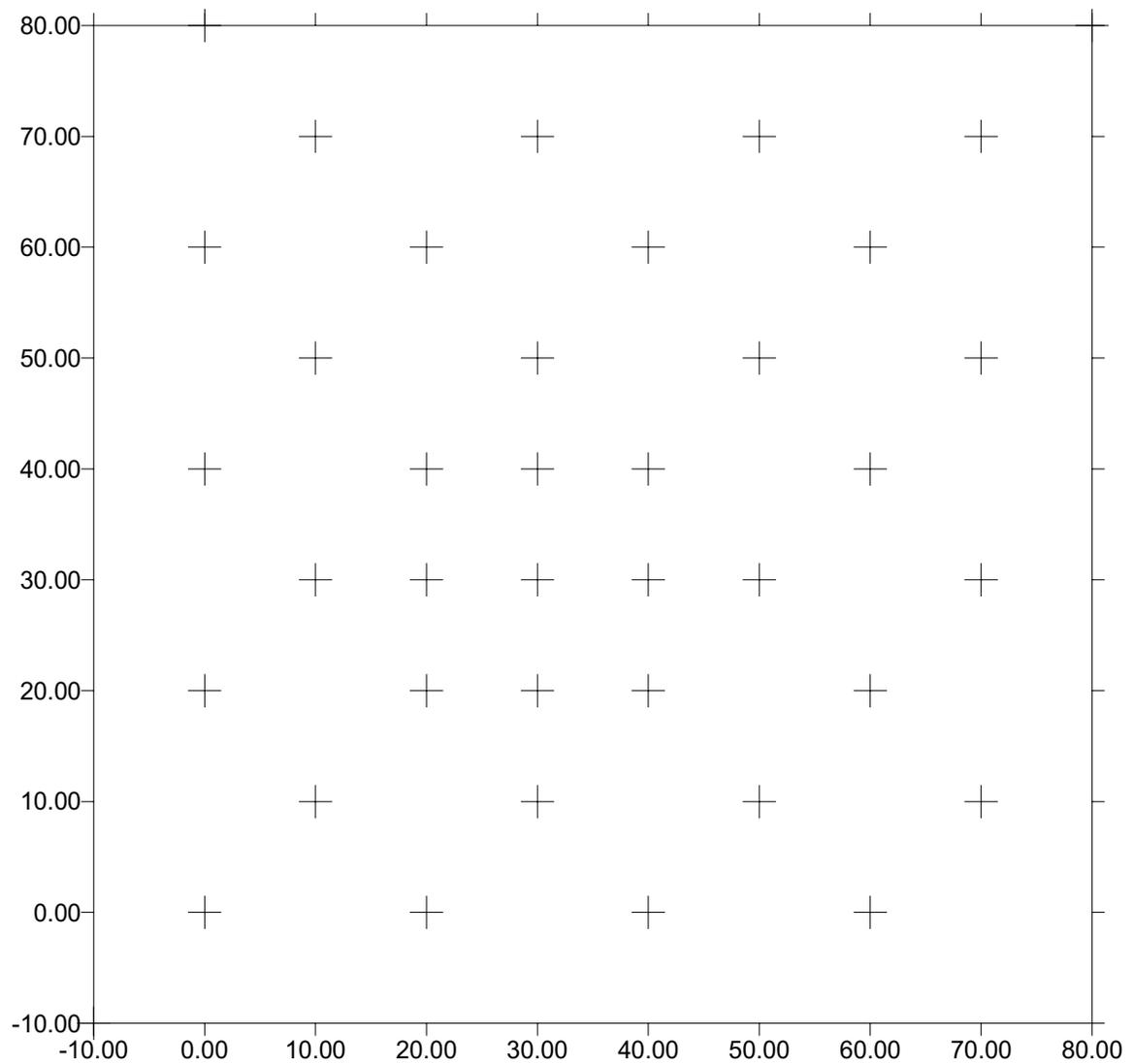
Figura 7- Malha de amostragem da Condutividade Hidráulica do Solo Saturado
