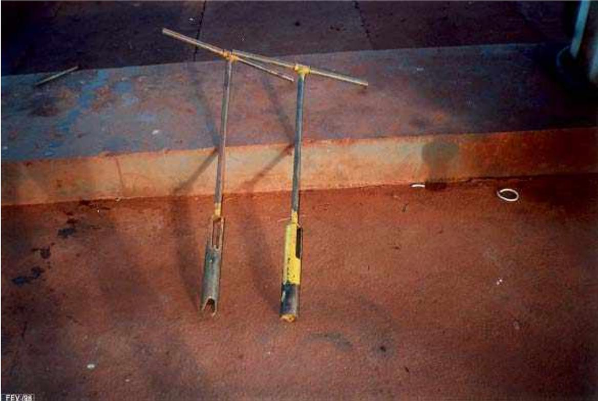
Figura 9. Trados utilizados na amostragem da condutividade hidráulica
