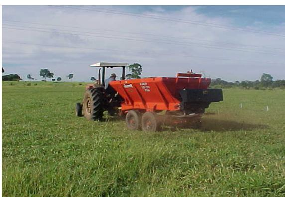
Figura 3 – Conjunto mecanizado utilizado para a distribuição superficial da cama de frango. (Foto: Leomar Paulo de Lima)
