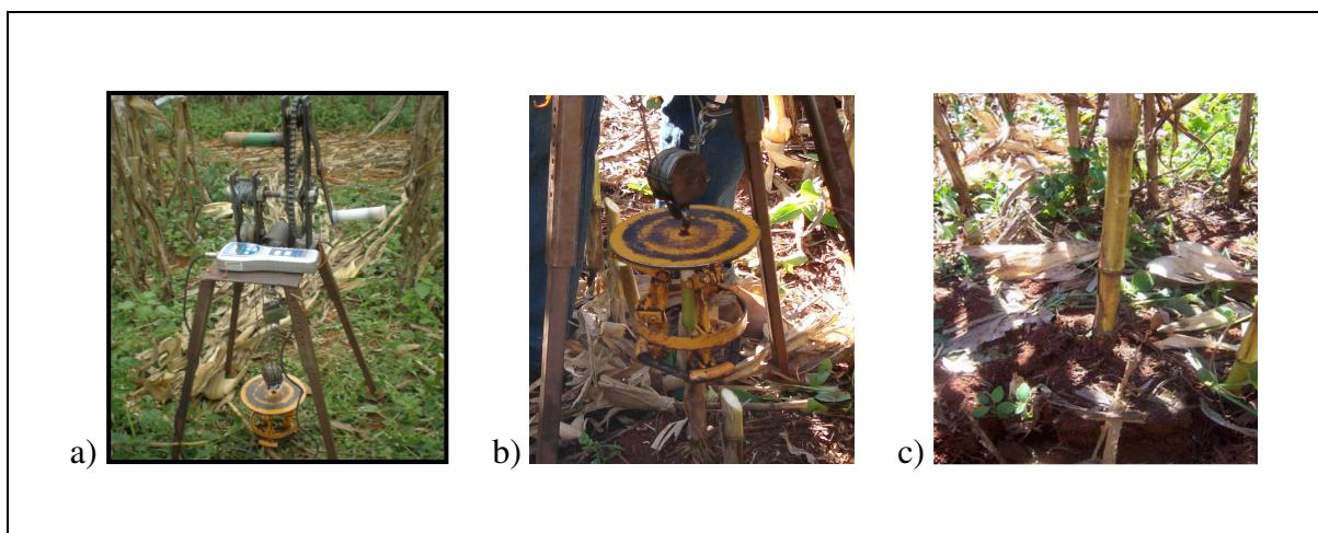
**Figura 1** – Arrancômetro: Equipamento utilizado para medir a força (Kgf) necessária para promover o arranquio da planta, 2008. a) vista lateral, b) garra de acoplagem a base do colmo, c) raiz arrancada pelo arrancômetro.
