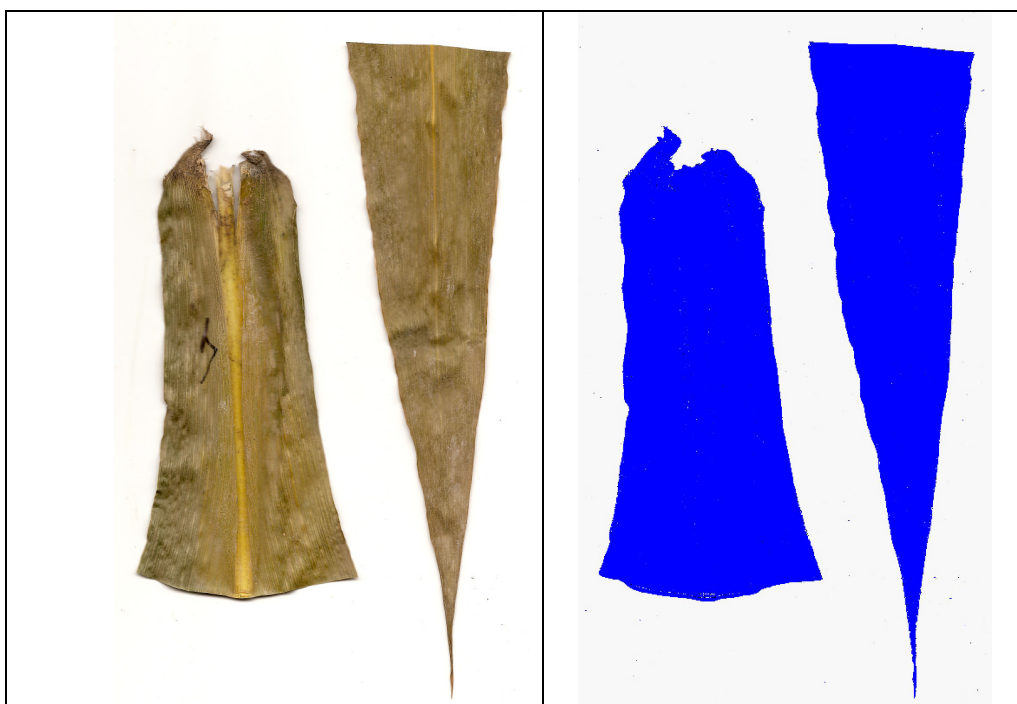
Figura 1: Transformação da imagem obtida no scanner a partir do programa QUANT com redução da imagem a duas cores padrão, Uberlândia, 2008.
