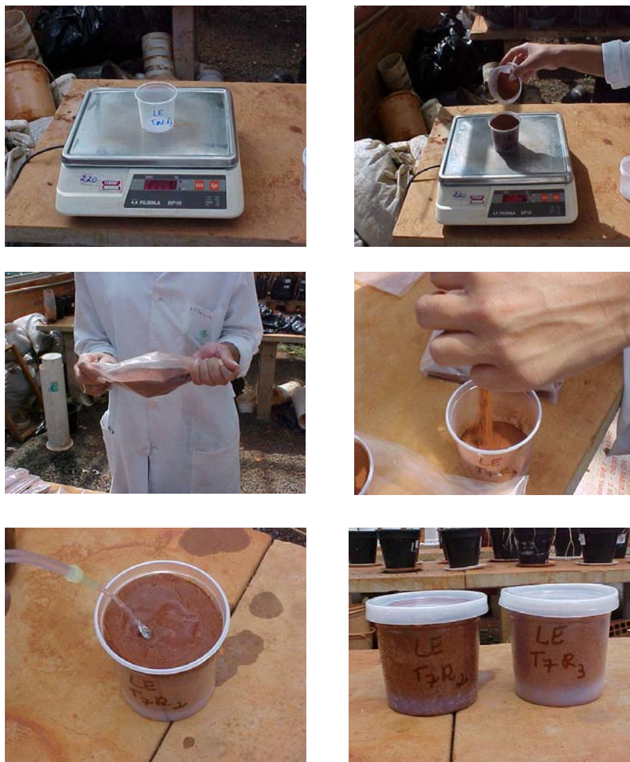
Figura 1. Procedimentos para instalação dos experimentos de reatividade.
