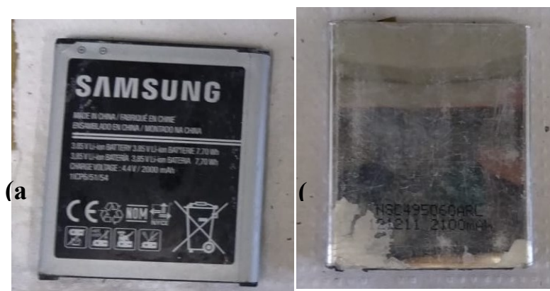
Figura 7 - a: Bateria com embalagem plástica; b: Carcaça metálica da bateria.
