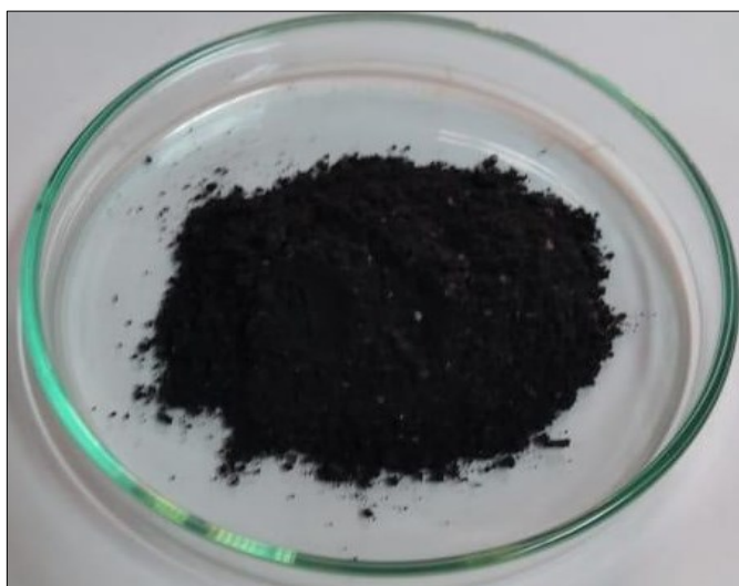
Figura 14 - Pó de bateria de íon de lítio obtida por cominuição dos materiais catódico e anódico presentes na bateria.
