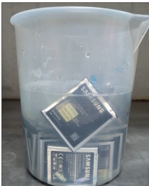
Figura 6 - Baterias em solução salina para o processo de descarga.
