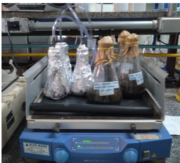
Figura 13 - Sistema dos ensaios de adaptação do consórcio microbiano (Erlenmeyers envoltos em papel alumínio) e do P. oxalicum (Erlenmeyers sem papel alumínio) aos metais Li e Co presentes nas baterias.
