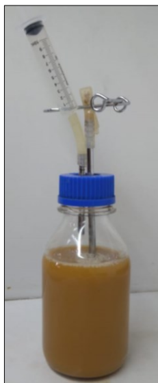
Figura 3 - Consórcio microbiano anaeróbico cultivado em meio sintético com PSL.
