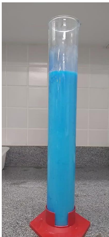
Figura 4 Ensaio de proveta com polpa de \text{CaCO}_3 tingida com azul de metileno
