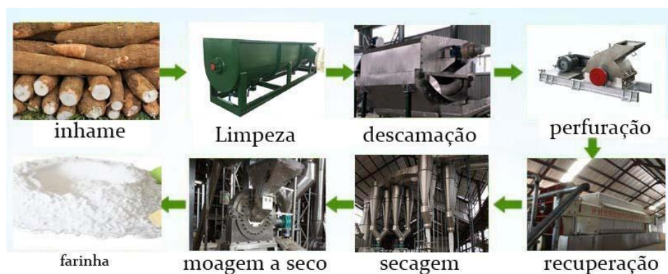
Figura 11 - Fluxograma de processamento de pó de inhame.
