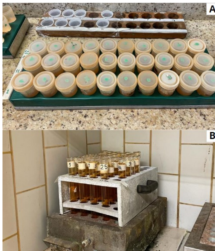
Figura 3. Imagens das análises laboratoriais para a determinação do teor de potássio trocável no solo por Mehlich-1 (A) e digestão foliar com ácido nitro-perclórico (B).
