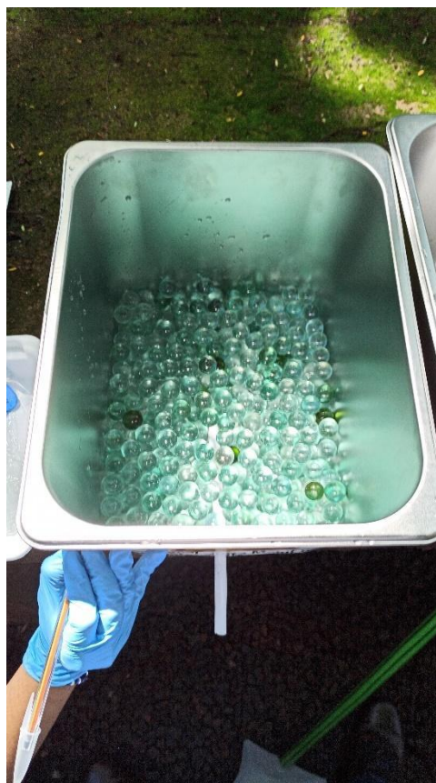
Figura 4. Cuba de inox tendo como base de drenagem bolas esféricas de vidro e saída de drenagem com mangueira.
