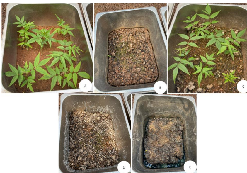
Figura 10. Ensaio de germinação com cedro ( Cedrela fissilis ) expostos ao solo (A). solo + lodo de esgoto (B). solo + lodo de esgoto estabilizado (C). Lodo de esgoto estabilizado (D). Lodo puro (E) da Estação de Tratamento de Esgoto Uberabinha (Uberlândia, MG).
