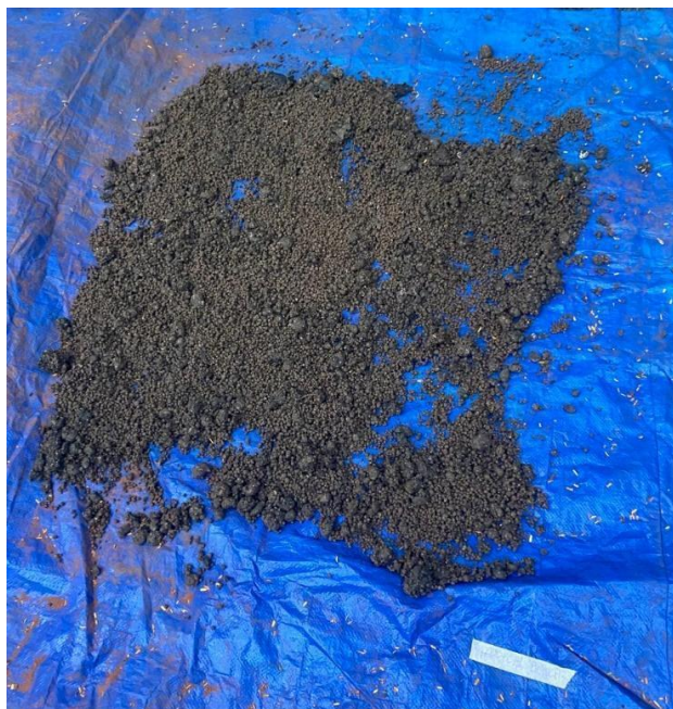
Figura 2. Lodo de esgoto da Estação de Tratamento de Esgoto Uberabinha (Uberlândia, MG) misturado com cal estabilizando no sol.
