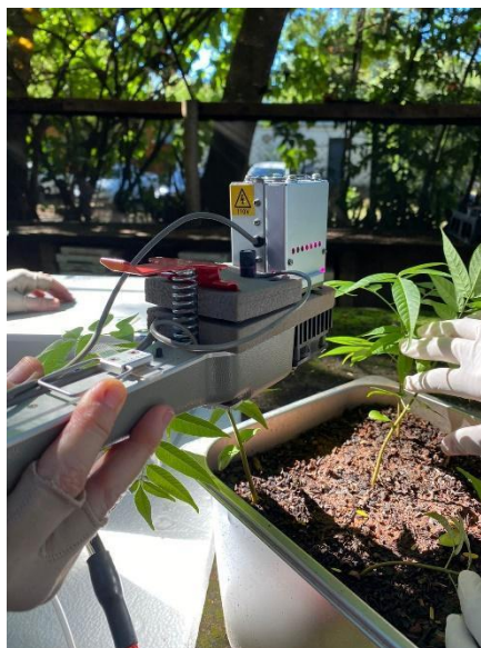
Figura 8. Medidor de troca gasosas foliares em sistema aberto portátil IRGA (LcPro-ADC Hoddesson UK) conectado à câmara foliar PLC4 (B) (6,25 cm 2 ).
