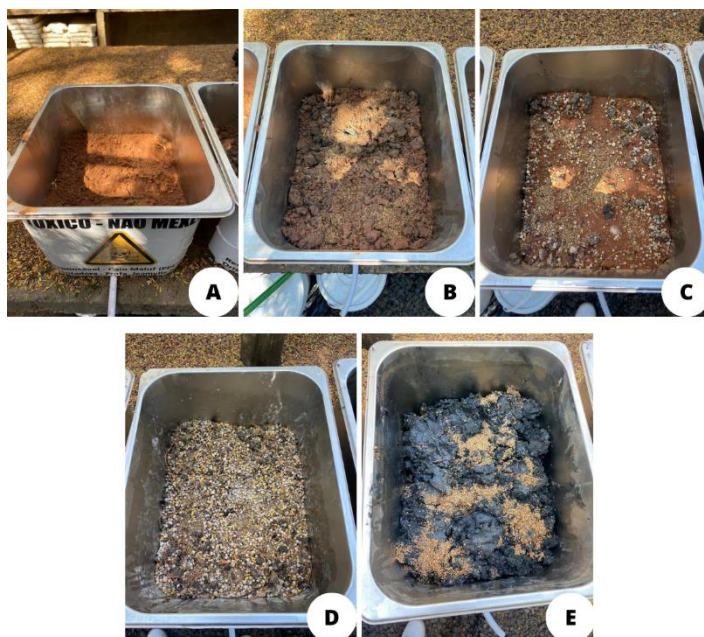
Figura 5. Montagem das cubas com amostras lodo de esgoto da Estação de Tratamento de Esgoto Uberabinha (Uberlândia, MG. solo (A), solo+ lodo de esgoto (B), solo+ lodo de esgoto estabilizado com cal (C), lodo de esgoto estabilizado com cal (D), lodo de esgoto (E).
