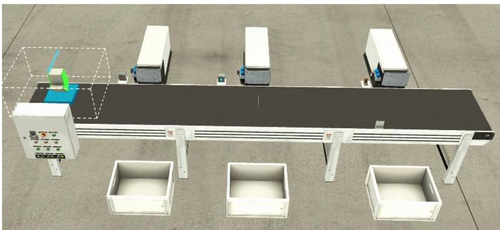
O primeiro material disposto sobre a esteira é azul, simulando o papel. Nas figura 53 e 54, são mostradas as capturas de tela dos softwares no instante que o objeto é identificado. É possível observar que o sensor capacitivo foi ativado e o tempo de contagem para ativar a saída Q do TON\_2 também.
