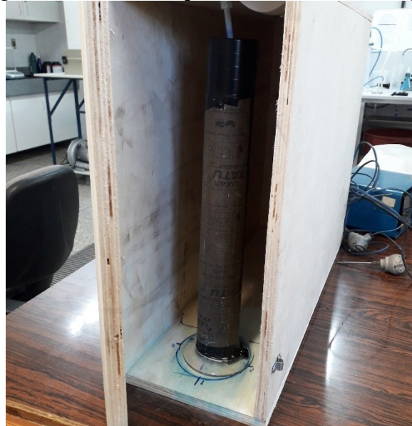
Figura 6 – Unidade experimental de sedimentação.
