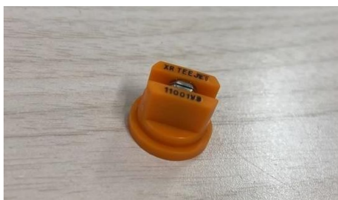
Figura 5: Ponta de pulverização utilizada (XR 11001). Fonte: Autoria própria, Gustavo Henrique Herval Matos (2023).
