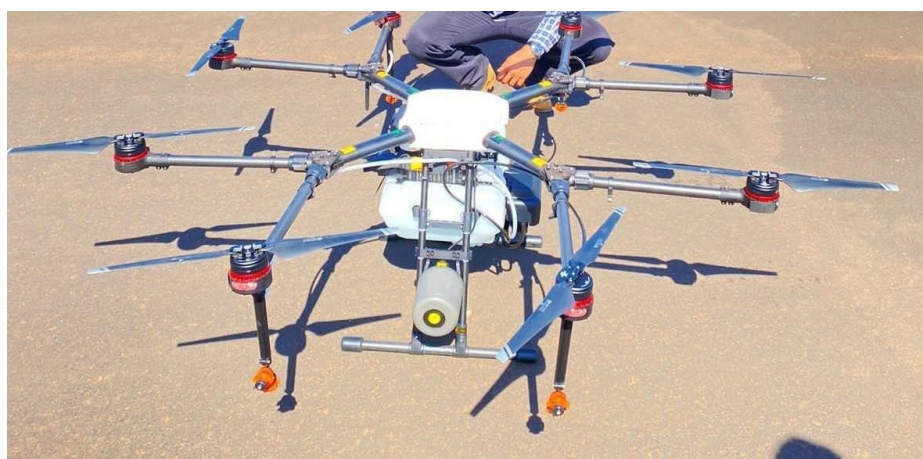
Figura 4: Aeronave remotamente pilotada DJI AGRAS MG-1P. Fonte: Autoria própria, Gustavo Henrique Herval Matos (2023).
