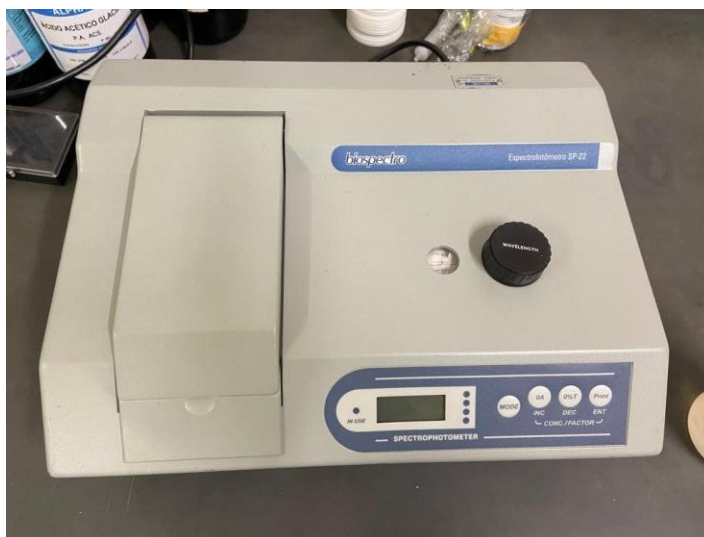
Figura 7: Espectrofotômetro empregado para determinação da deposição de calda. Fonte: Autoria própria, Gustavo Henrique Herval Matos (2023).
