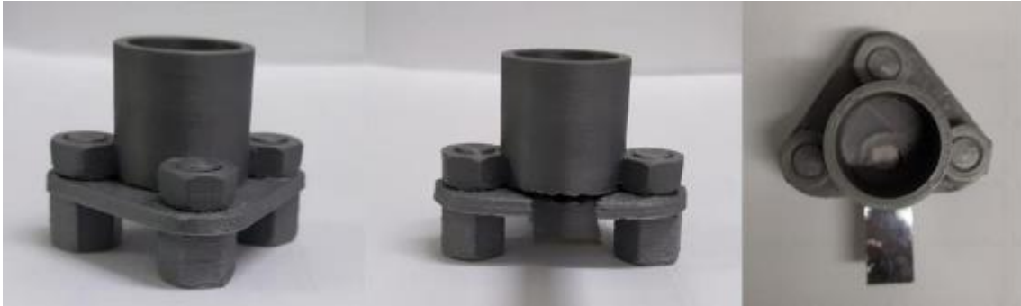
Figura 14. Célula impressa por impressão 3D no laboratório.
