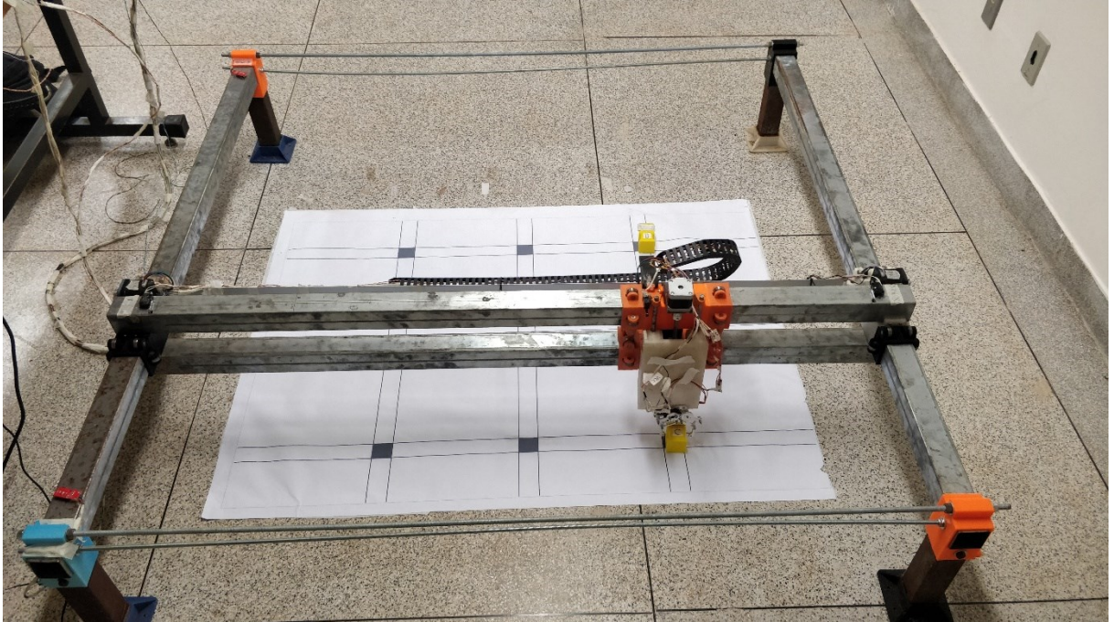
Figura 13 – Robô cartesiano utilizado no trabalho
