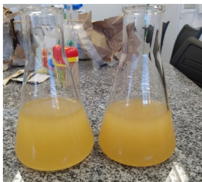
Figura 1. Extração do biossurfactante em Erlenmeyers a partir do método da acetona fria. Fonte: Próprio autor.
