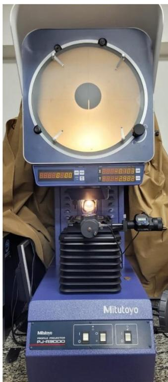
Figura 3.4 – Projetor de Perfil para medição do comprimento do entalhe.
