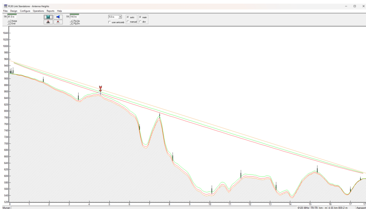
Figura 62 - Dimensionamento da altura das antenas para o enlace Munari - Agroporto.
