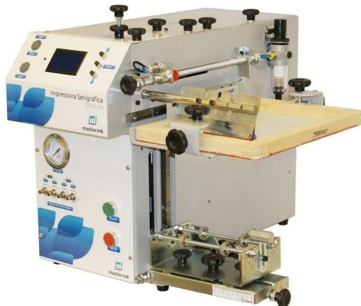
Figura 4 – Maquinário Semi – automático para objetos cilíndricos Fonte: Pesquisa – ação
