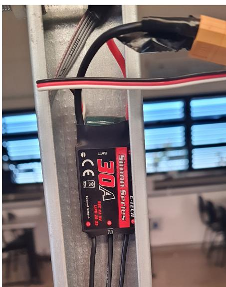
Figura 4 – Controlador eletrônico de velocidade.
