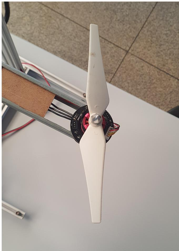
Figura 5 – Hélice do conjunto propulsor.
