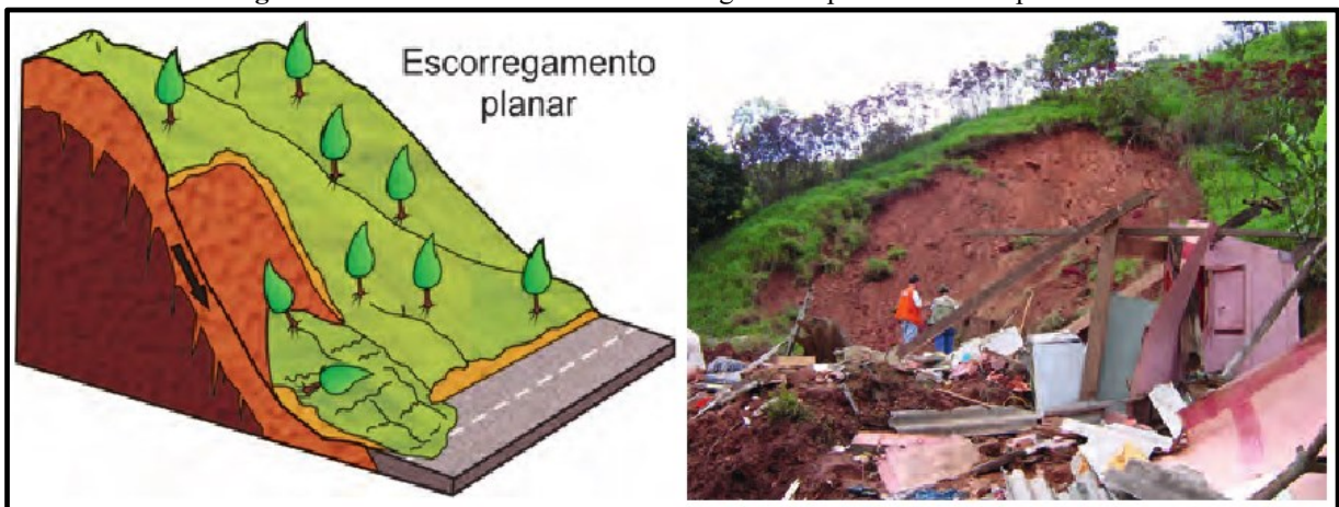
Figura 11: Funcionamento de um escorregamento planar e seus impactos.
