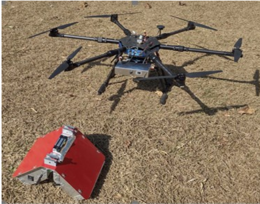
Figura 22: Módulo para remover detritos carbonizáveis da LT.
