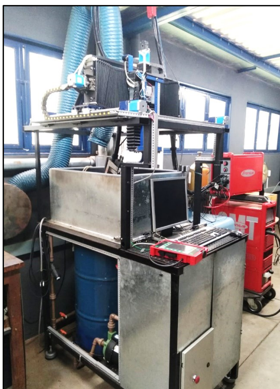
Figura 3.5 – Mesa de coordenadas CNC com eixos XYZW independentes
