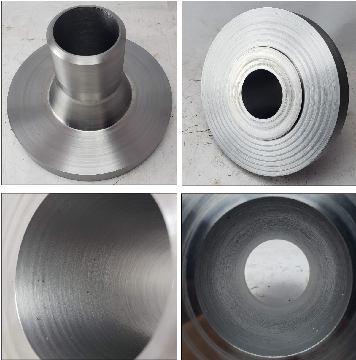
Figura 4.40– Imagens do flange 2 como usinado.
