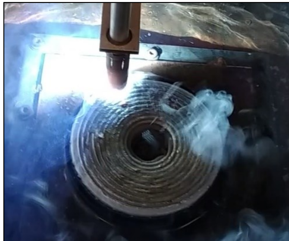
Figura 4.4 – Imagem da deposição (base) do flange com o Robô com RAQI.
