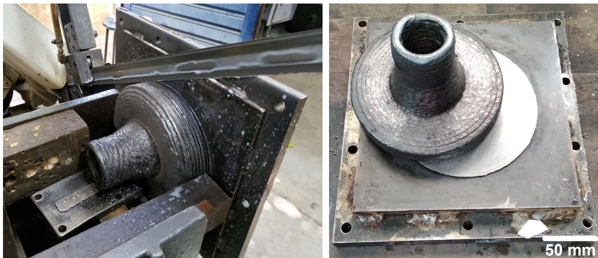
Figura 4.9 – Peça depositada fixada a Serra de fita (esquerda); Vista da seção do corte realizado para separação do metal depositado do substrato (direita)
