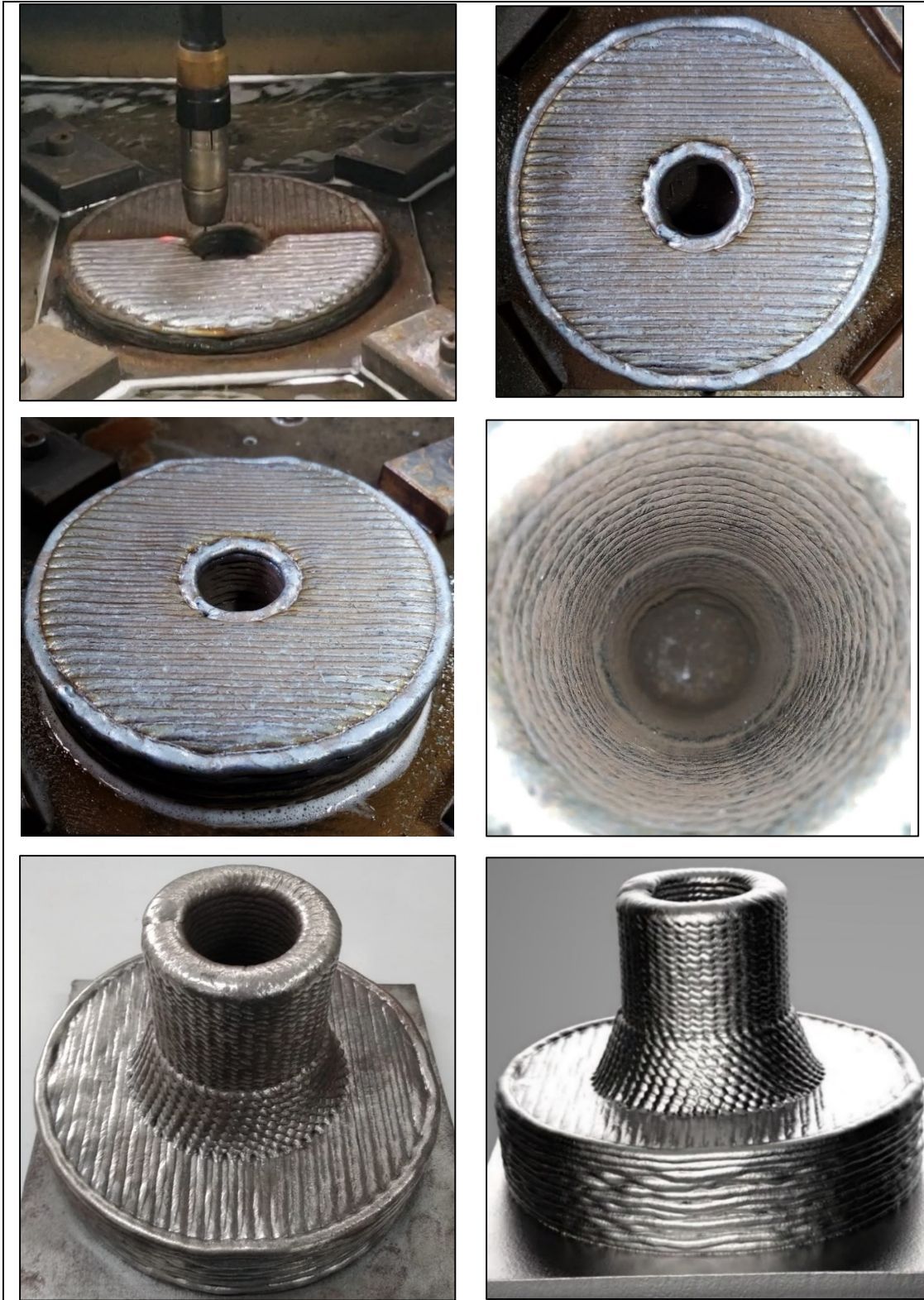
Figura 4.43 – Imagens da deposição do Flange 3
