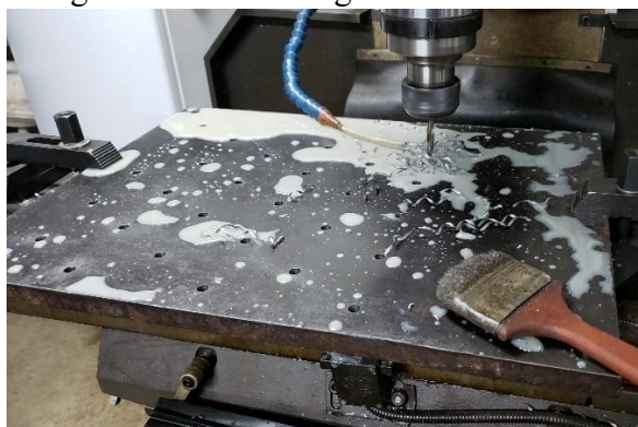
Figura 0.12 – Furação da plataforma de construção
