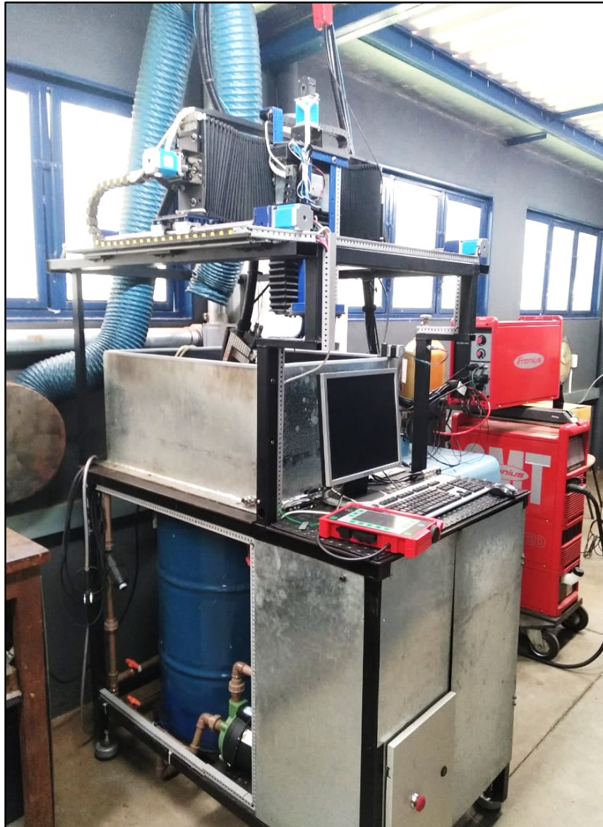
Figura 0.18 – Retrofit do equipamento de manufatura aditiva arco com 3 eixos concluído
