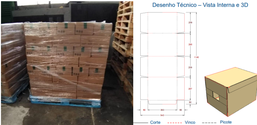
Figura 2: palete PBR com o produto e medidas da embalagem de papelão.
