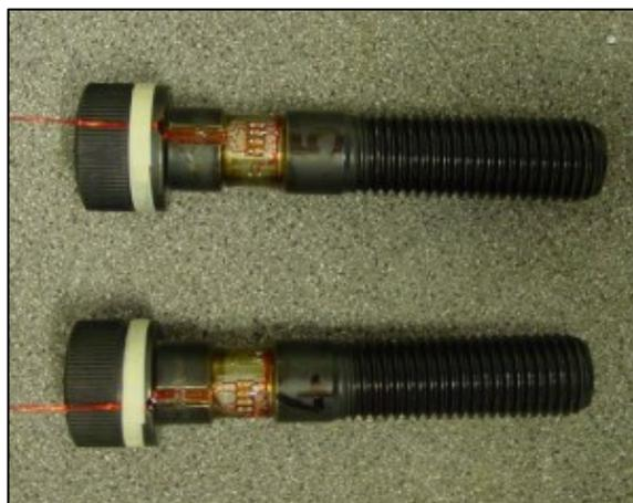
Figura 14 – Fixação de extensômetros em parafuso (NIKRAVESH e M. GOUDARZI, 2017).
