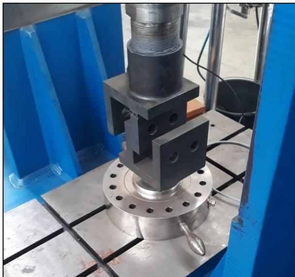
Figura 24 – Detalhe da garra fabricada para os ensaios de perda de pré-tensão.
