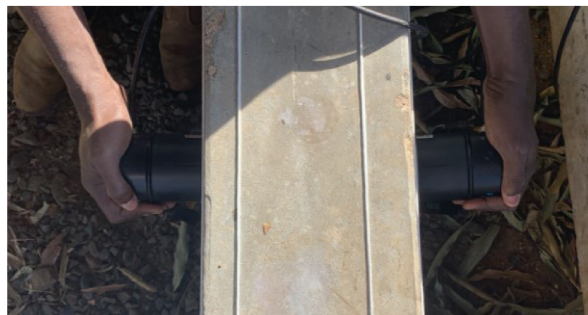
Figura 95: Posição dos transdutores para ensaio de módulo dinâmico (faces 1-3).
