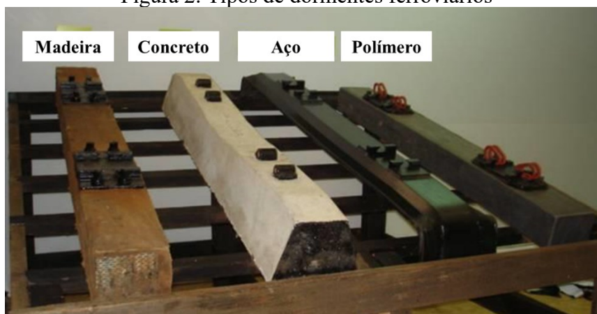
Figura 2. Tipos de dormentes ferroviários
