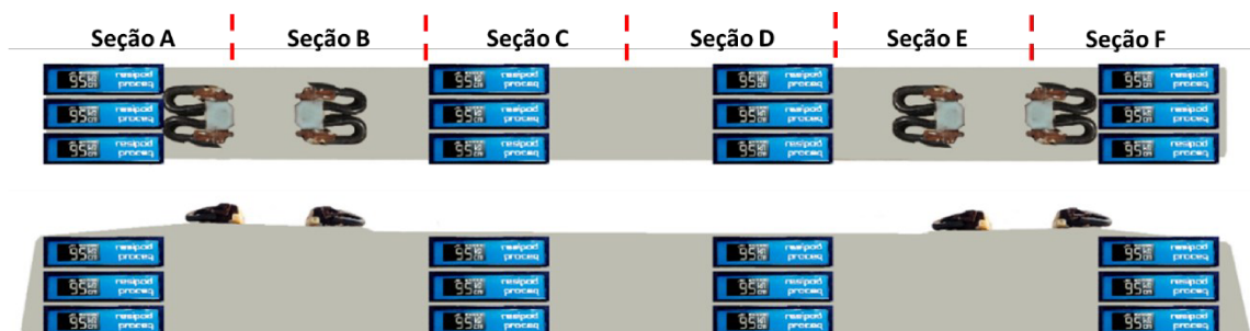
Figura 97: Posição do equipamento de resistividade elétrica em cada seção
