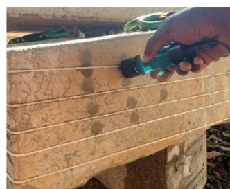
Figura 99: Posições para ensaio do eletrodo de potencial
