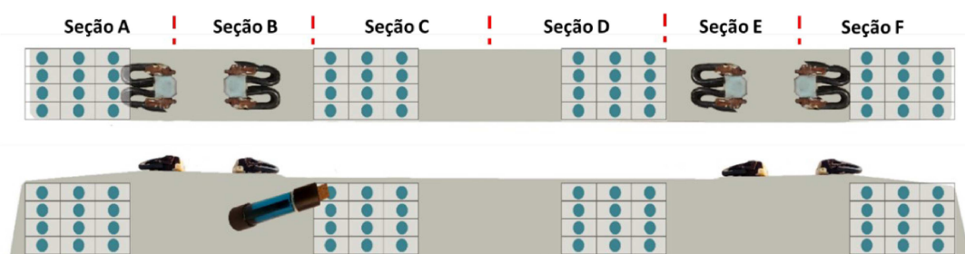
Figura 99: Posições para ensaio do eletrodo de potencial
