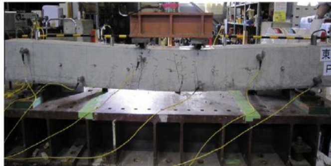
Figura 40. Padrão de falha da viga ensaiada na carga máxima
