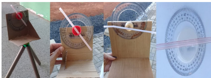
Figura 1: Teodolitos construídos pelos alunos.
