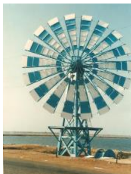
Figura 10 - Moinho com rotor multipás
