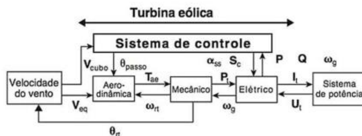
Figura 6 - Sistema de controle de uma turbina eólica
