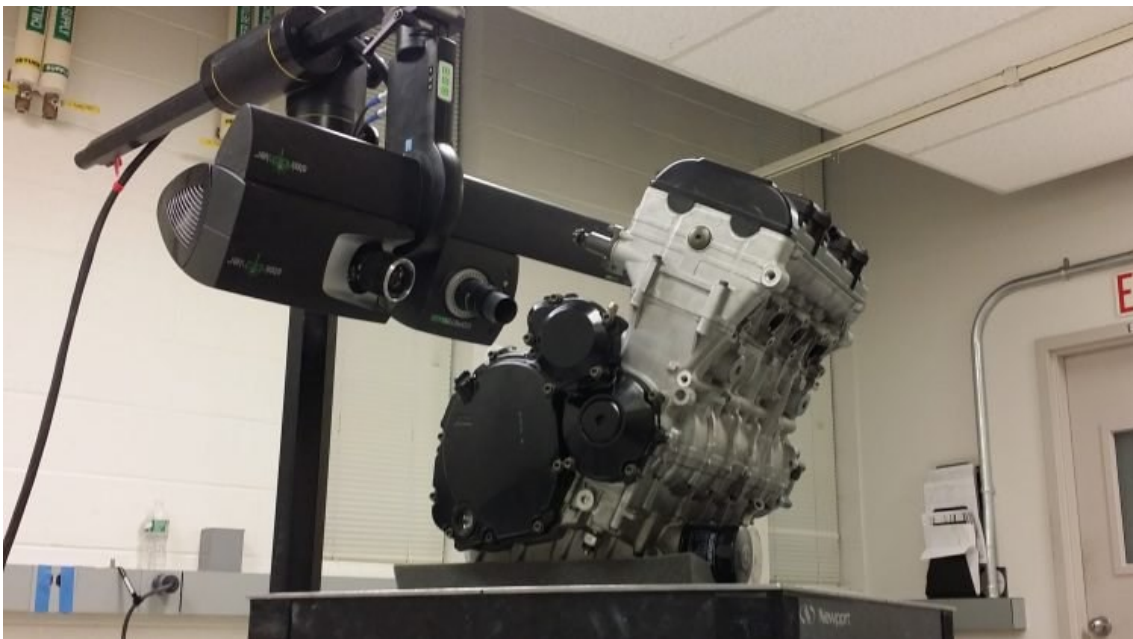
Figura 2.2 – Digitalização 3D de um motor Suzuki GSX-R600
