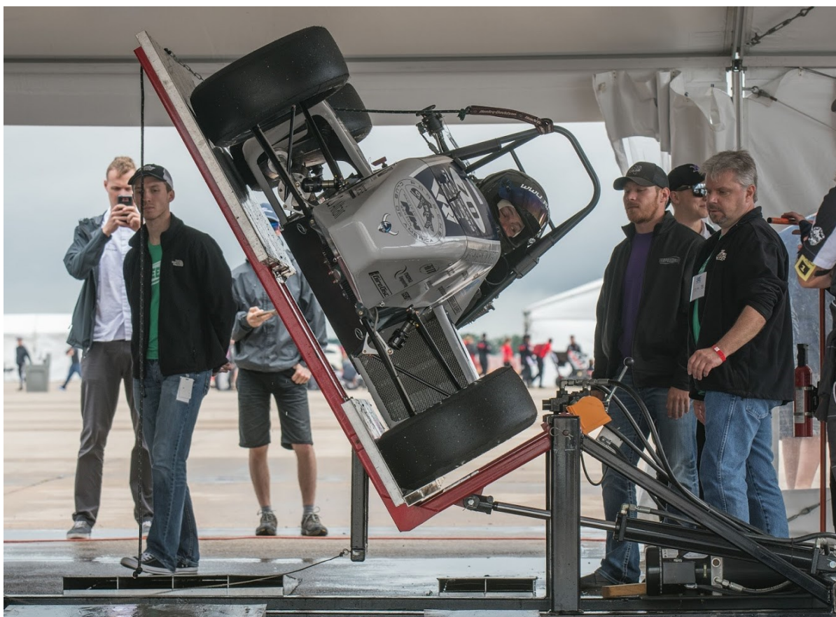
Figura 2.1 – Teste de inclinação realizada durante a competição
