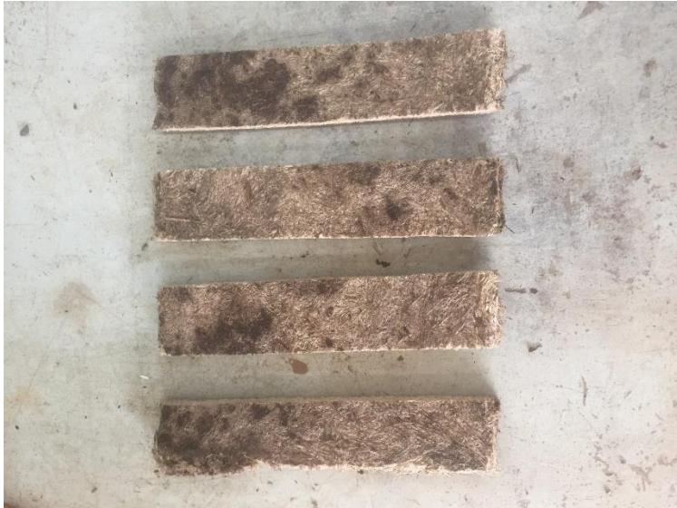
Figura 16 e 17 – CP seco e fatiado, nas dimensões de 200mm x 40mm x 14mm.
