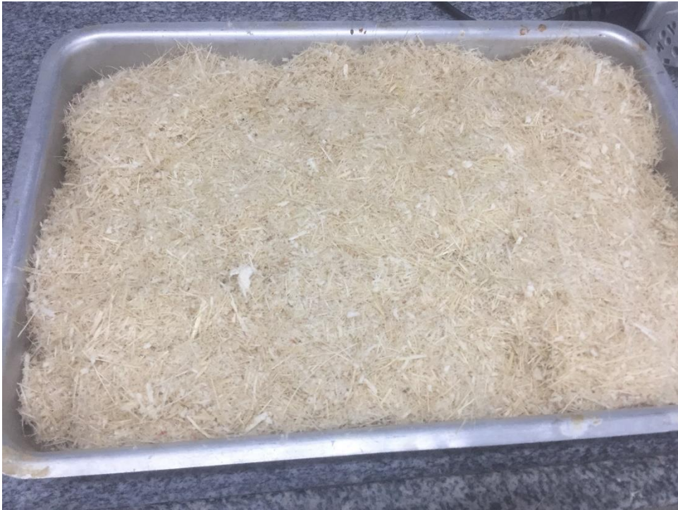
Figura 6 – Bagaço de cana seco após 24horas na estufa a 60°C.
