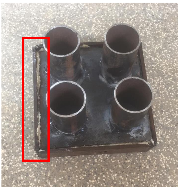
Figura 13 – Falha na vedação do molde.
