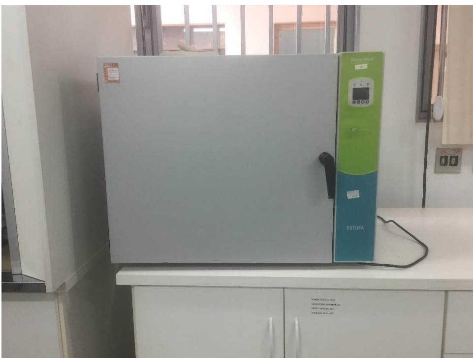
Figura 5 – Estufa com circulação de ar, marca odontobras, modelo MOL – EL – 1.3, 1000W.
