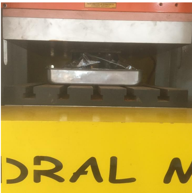
Figura 11 – CP sendo compactado na prensa hidráulico-térmica.
