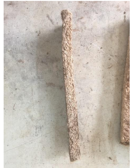
Figura 16 e 17 – CP seco e fatiado, nas dimensões de 200mm x 40mm x 14mm.
