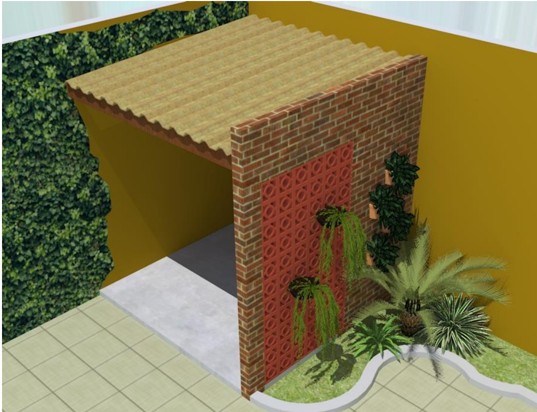
Figura 25 – De acordo com suas características e resistência constatada nos ensaios, foi apresentado um protótipo de cobertura ecológica, que pode substituir até mesmo as convencionais telhas de fibrocimento.
