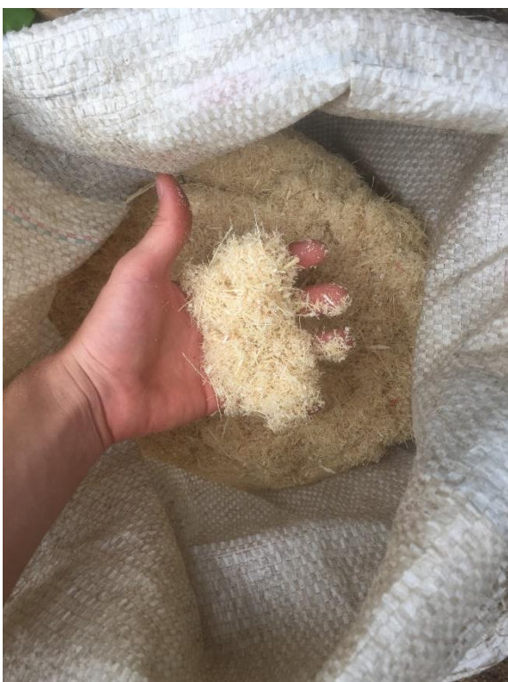
Figura 4 – Bagaço triturado com fibras em tamanho médio de 8mm
