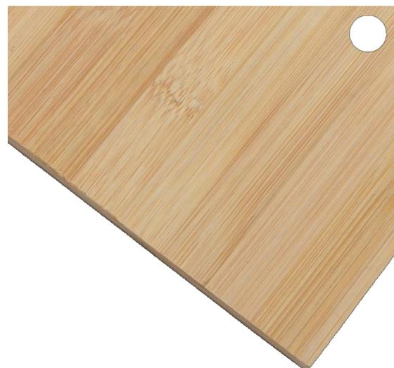
Figura 55: Bambu laminado. Fonte: Bambusa Estúdio
