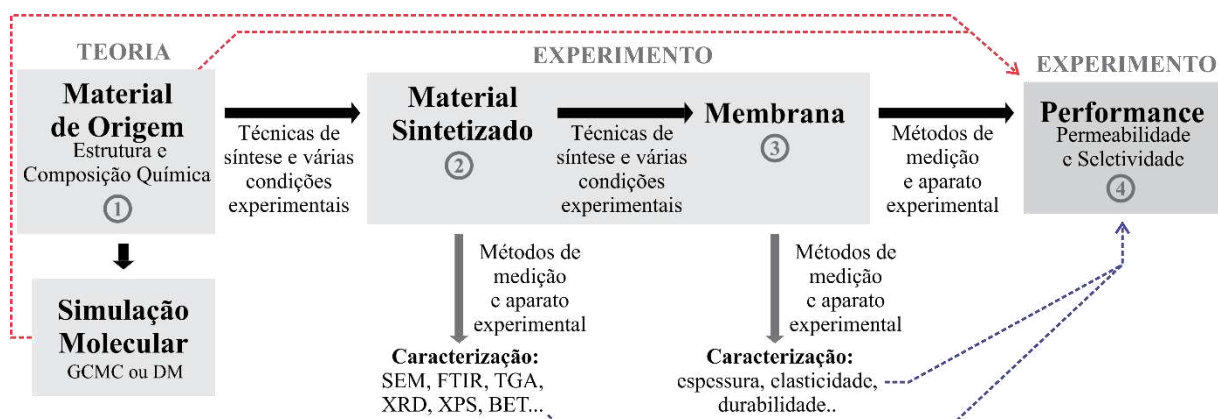
Figura 1 – Diagrama das etapas do projeto de uma membrana e suas variáveis de influência. LEGENDA: ■ Utilizando descritores teóricos; ■ Utilizando descritores experimentais.
