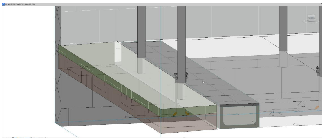
Figura 18 – Conflito entre SPDA e calha.
