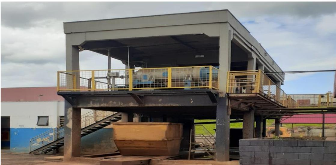
Figura 14. Centrifuga e caçamba de lodo para compostagem. Fonte: Autor.
