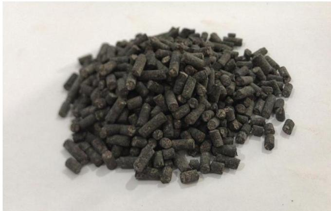
Figura 5 - Fertilizante Organomineral após passar pela peletização vertical
