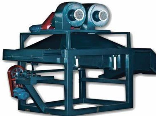
Figura 6.- Sistema de Resfriamento e peneiramento fertilizantes organominerais.
