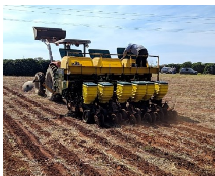
Figura 3: plantio do feijoeiro por meio de semeadora de arrasto em sistema de plantio direto.
