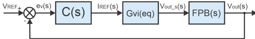
Figura 4. 12 - Diagrama de blocos do sistema equivalente aproximado do conversor RHTB em malha fechada.
