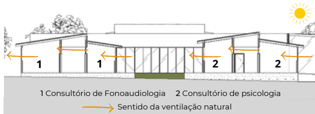
Corte esquemático representando a ventilação e iluminação natural. Fonte: Elaborado pela autora.
