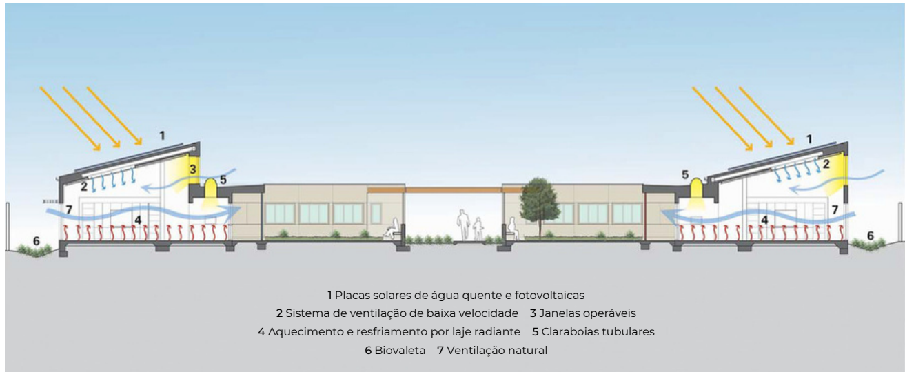
Corte AA representando as estratégias de conforto ambiental. Fonte: Archidaily, 2013, adaptada pela autora.
