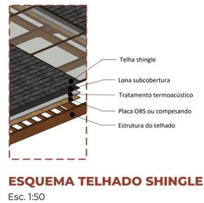
**ESQUEMA TELHADO SHINGLE**
